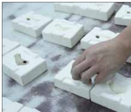
2. Öffnen der Gipsform Opening the plaster mold
