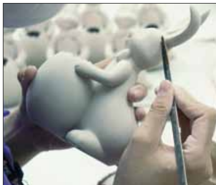
4. Verputzen der Gießnähte Cleaning the casting lines
