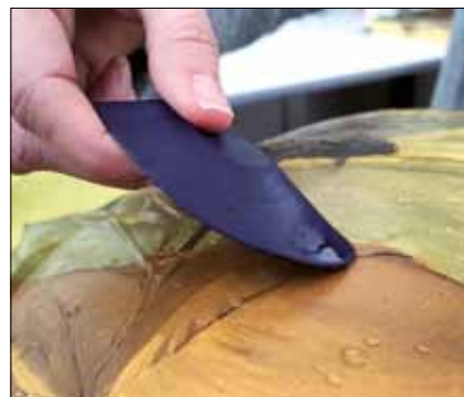
Feststrahlen des Dekorbildes Squeegeeing of the decal Raclage de la décalcomanie
